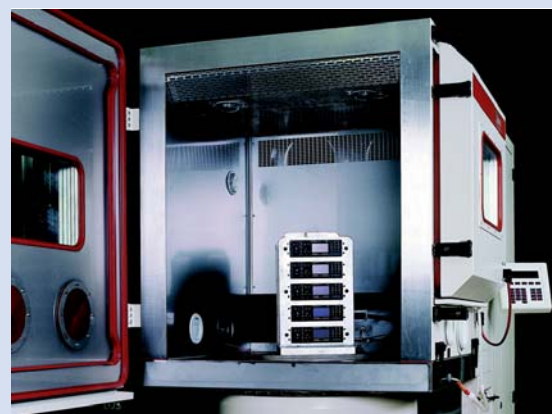
Essais combinés (vibration et température) d'autoradios, Blaupunkt GmbH, Hildesheim / Allemagne
