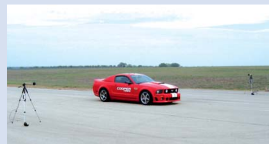
Vorbeifahrtmessungen beim Reifenhersteller Cooper Tire, USA
