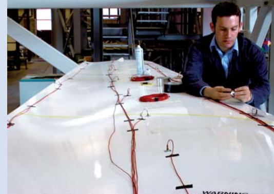
Untersuchung der A340 Winglets bei Stirling Dynamics, England
