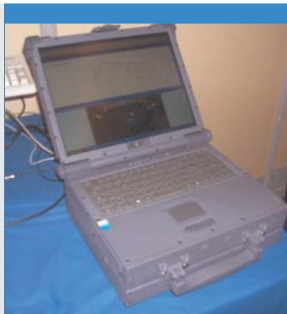
Photo n°1 Portable durci Beltronic A770 avec extension solidaire à 2 PCI
