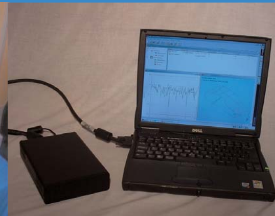
Photo n°2 Portable avec boîtier PCI via PCMCIA
