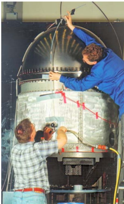
Dehnungsmessungen an einem ATV-Tank (Automatic Transport Vehicle) bei der EADS Deutschland GmbH, Ottobrunn
